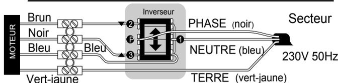
Dans le cas d'un moteur radio, raccorder le «Bleu» au Neutre et le «Brun» à la Phase du secteur. Le «Vert-Jaune» à la Terre.
