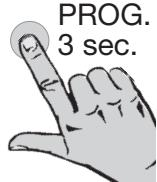
Appuyez pendant 3 secondes sur la touche **PROG** d'un émetteur déjà programmé (attendre jusqu'à ce que la LED clignote **une fois**). L'activation de ce mode de programmation est signalée par un bref mouvement de montée/descente du moteur.
