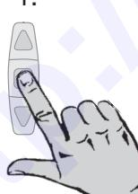
Bei Erreichen der gewünschten Zwischenposition halten Sie die **STOPP**-Taste gedrückt und korrigieren Sie, falls erforderlich, die Position mit der **AUF**- oder **AB**-Taste. Lassen Sie die **STOPP**-Taste los, wenn die exakte Position erreicht ist.
