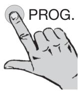
Appuyez ensuite brièvement sur la touche **PROG** de l'émetteur à déprogrammer. L'émetteur est déprogrammé et n'est plus reconnu par le récepteur.
