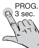
Drücken Sie innerhalb von ca. 4 Minuten bei dem neuen Sender die **PROG**-Taste für 3 Sekunden (warten, bis die Sendekontrollleuchte **einmal** blinkt).
