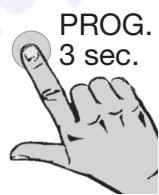
Drücken Sie bei einem bereits eingelernten Sender die **PROG-Taste** für 3 Sekunden (warten, bis die Sendekontrollleuchte **einmal** blinkt). Anschließend befindet sich der Empfänger für 1 Minute in Lernbereitschaft.
