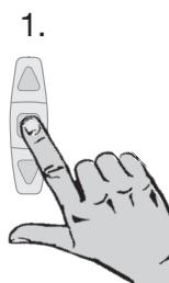
Bei Erreichen der gewünschten Zwischenposition halten Sie die **STOPP**-Taste gedrückt und korrigieren Sie, falls erforderlich, die Position mit der **AUF**- oder **AB**-Taste. Lassen Sie die **STOPP**-Taste los, wenn die exakte Position erreicht ist.
