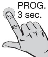
Pour déprogrammer un émetteur, appuyez pendant 3 secondes sur la touche **PROG** de l'émetteur que vous désirez conserver (attendre jusqu'à ce que la LED clignote **une fois**). L'activation de la procédure de déprogrammation est signalée par un bref mouvement de montée/descente du moteur.
